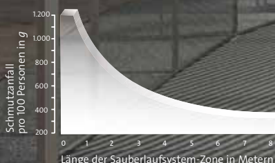
Abnahme des Schmutzanfalls in Relation zur Länge der Sauberlaufsystem-Zone
